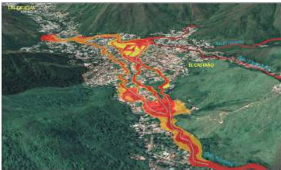
Vista 3D desde el ápice o zona apical del abanico aluvial de la quebrada Palmarito. Permite detallar las zonas afectadas por evento hidrogeomorfológico calificado como un flujo de detritos o alud torrencial
