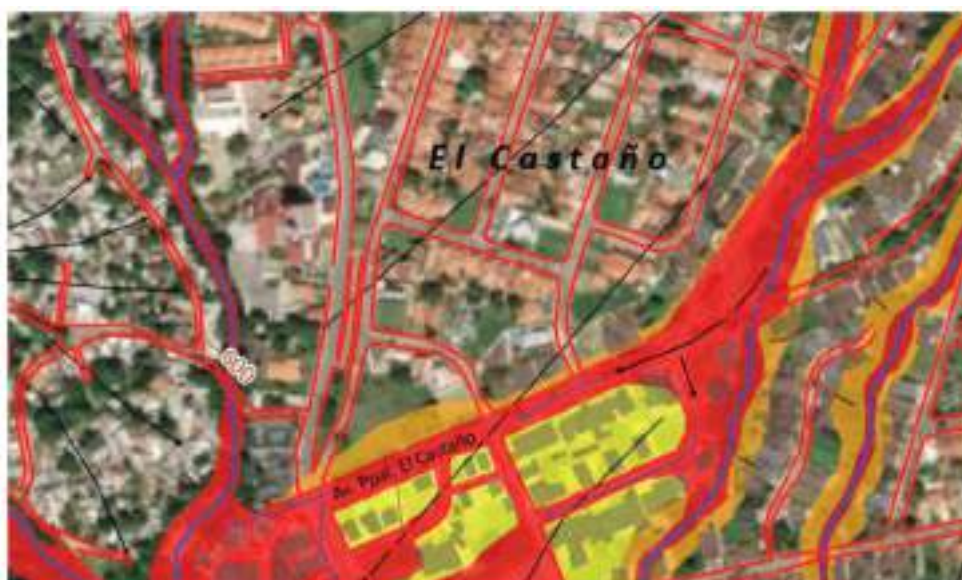
Con respecto al desbordamiento en la sección del puente sobre la quebrada Palmarito en confluencia con la Av. Ppal. El Castaño, se observa que la vialidad fungió como canales por donde transitó el flujo desbordado.
